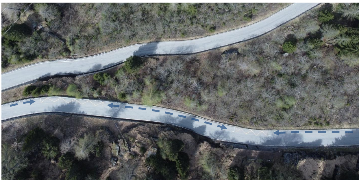
Figura 36: spazi di sosta a lato strada (evidenziati da frecce blu) intervallati da baie (in segnaletica orizzontale gialla) per agevolare i transiti in doppio senso di marcia
