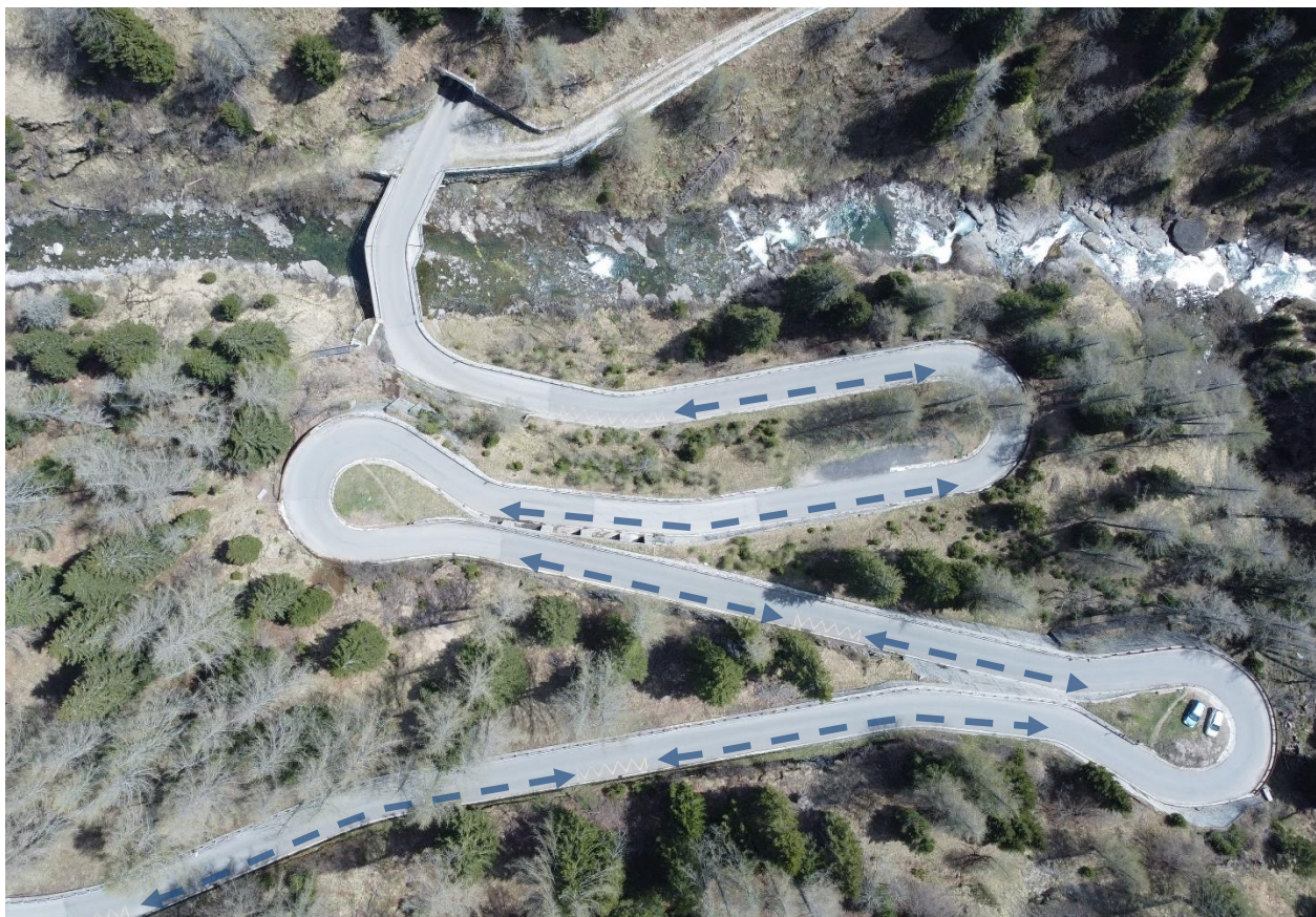
Figura 30: spazi di sosta a lato strada (evidenziati da frecce blu) intervallati da baie (in segnaletica orizzontale gialla) per agevolare i transiti in doppio senso di marcia
